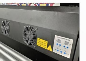
Мощная ИК-сушка с электронной регулировкой мощности излучения
